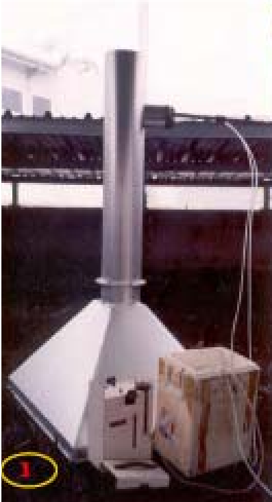
Figura 10: Particolare della cappa statica e dei fogli di materiale plastico da disporre intorno alla bocca di presa.
